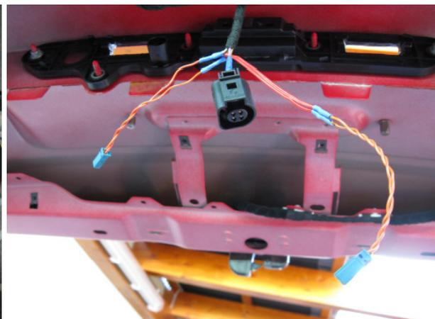
Widerstandsdekade zur Vernichtung der Verlustleistung parallel zu den beiden LED-Kennzeichenleuchten (habe mich für 5Stk. 15 $\Omega$  1W-Widerstände in Serie entschieden, ergibt 75 $\Omega$  und etwa einen Stromfluss von 160mA):
