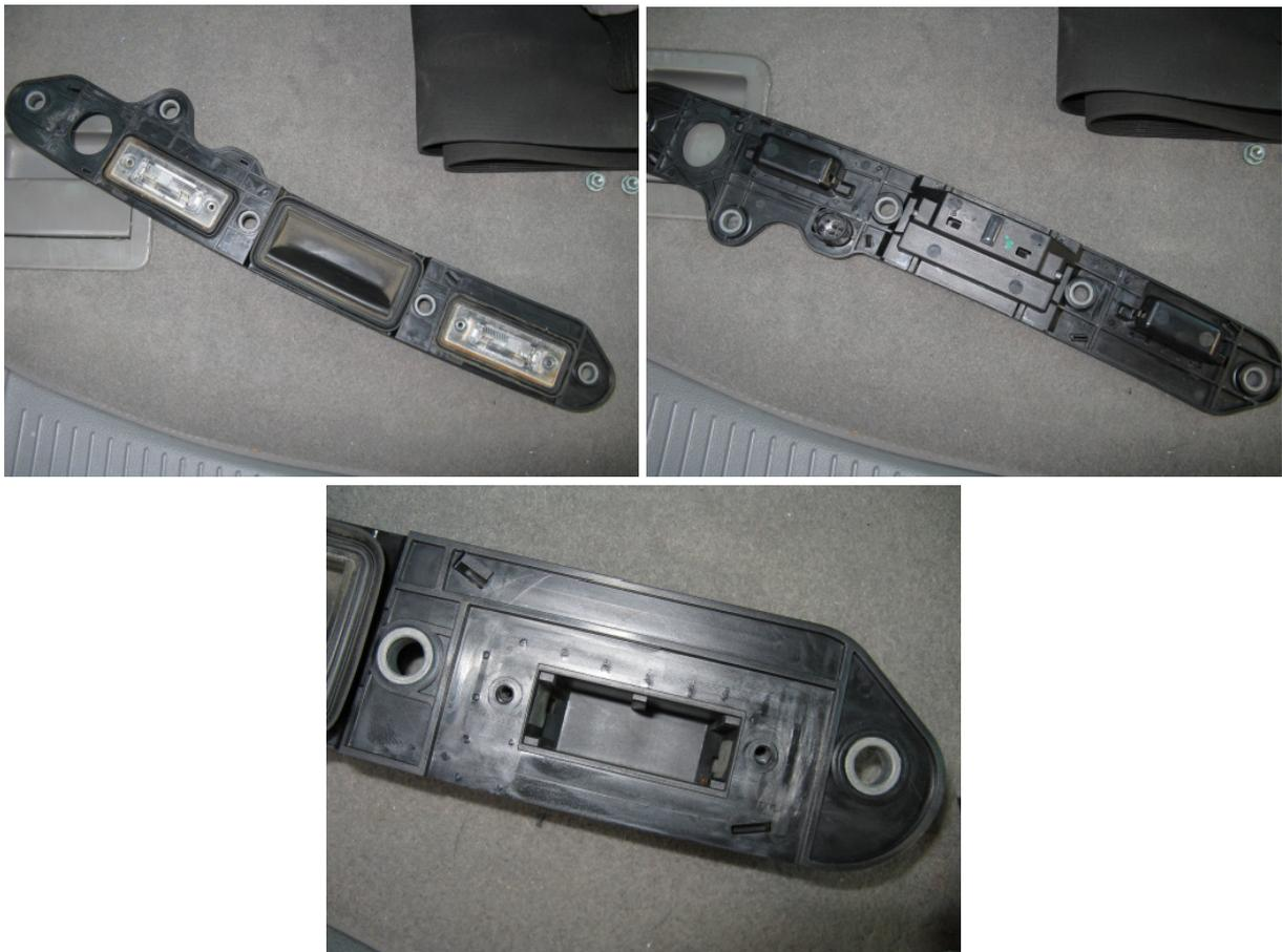
Zu Beginn muss das Gehäuse der originalen Leuchten annähernd vollständig entfernt werden, damit die LED-Leuchten eingesetzt werden können:
