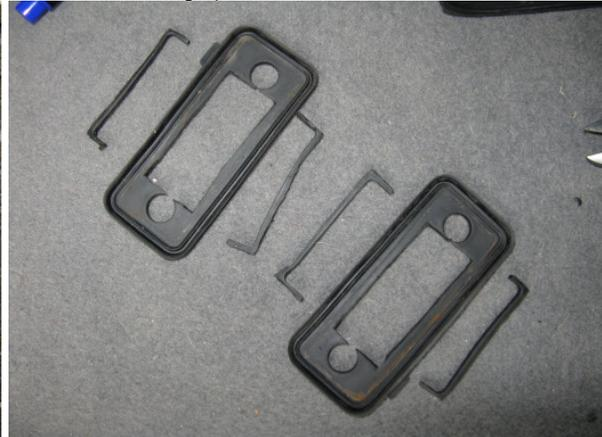
Zur Befestigung der LED-Kennzeichenleuchten muss deren Gehäuse noch etwas verkleinert werden und die Rastnasen entfernt, anstelle dieser werden zwei Schraubenlöcher gebohrt. Danach kann das ganze zusammengebaut werden; die Widerstände werden zur Kühlung auf der Rückseite der mittleren Blechabdeckung befestigt:
