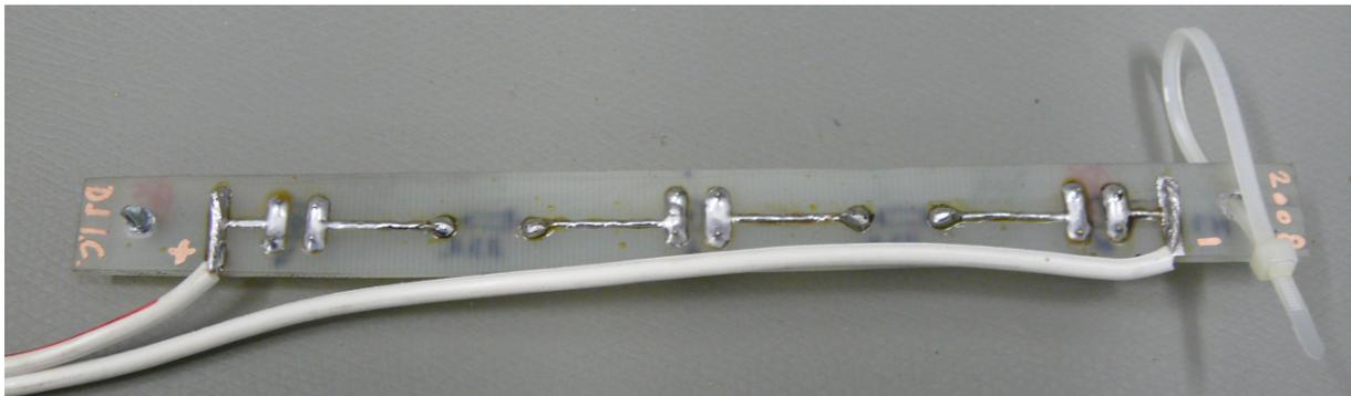
Die Montage der LEDs wurde zusätzlich schräg gewählt um einen größeren Abstrahlwinkel zu erzielen:
