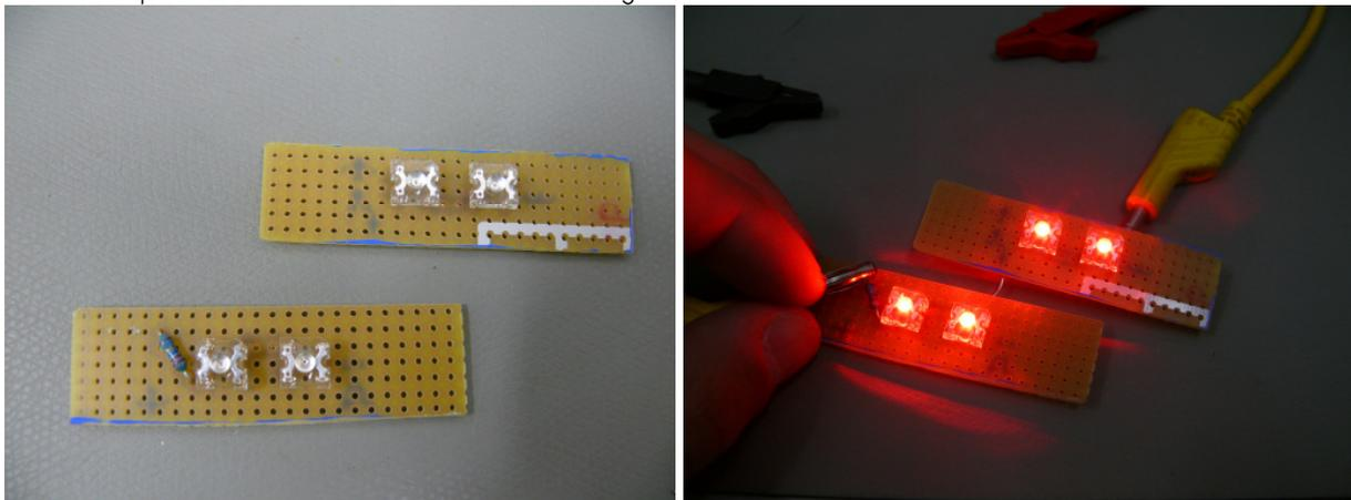
Um Strom zu sparen wurden die LEDs der beiden Seiten in Serie verkabelt:
